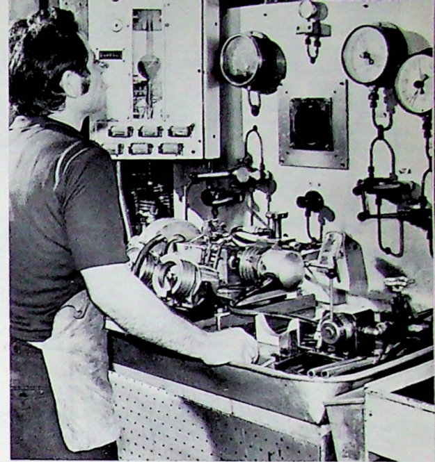
▲ Essai de chaque pompe finie.
