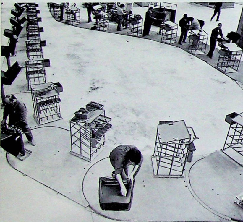
Le carrousel de montage des sièges-avant : le monteur se déplace avec l'écaille supportant le poste de travail : il peut assurer lui-même tout le travail correspondant à un siège. Capacité maximum du carrousel : une voiture, toutes les 80 secondes.
