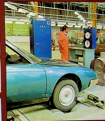
L'épreuve du banc à rouleaux : toutes les manœuvres jusqu'à une vitesse maxi de 150 km/heure.
