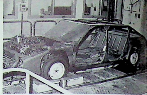
Une Cx-fantôme sur le banc à rouleaux. Seul le soubassement est réel; la forme n'étant pas définitivement déterminée lors de l'essai, la partie supérieure a été simulée par des tubes et des tôles.
